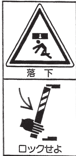
① 安全ラベル：警告（落下）
